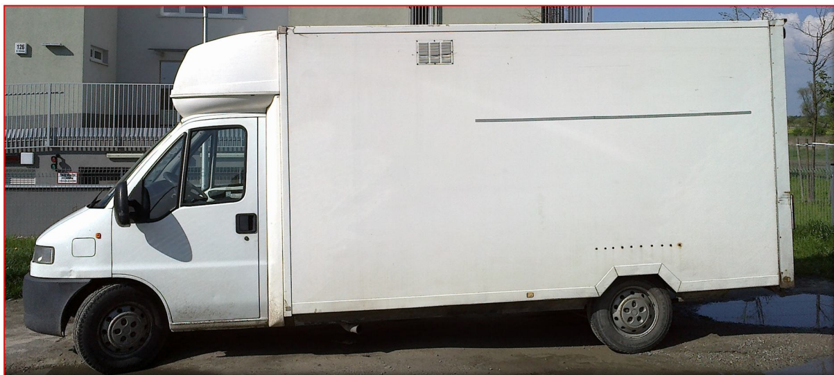
Peugeot Boxer, Zabudowa kontener niskozawieszony, wymiary 4,2x2,0x2,0, objętość 16m 3 .
