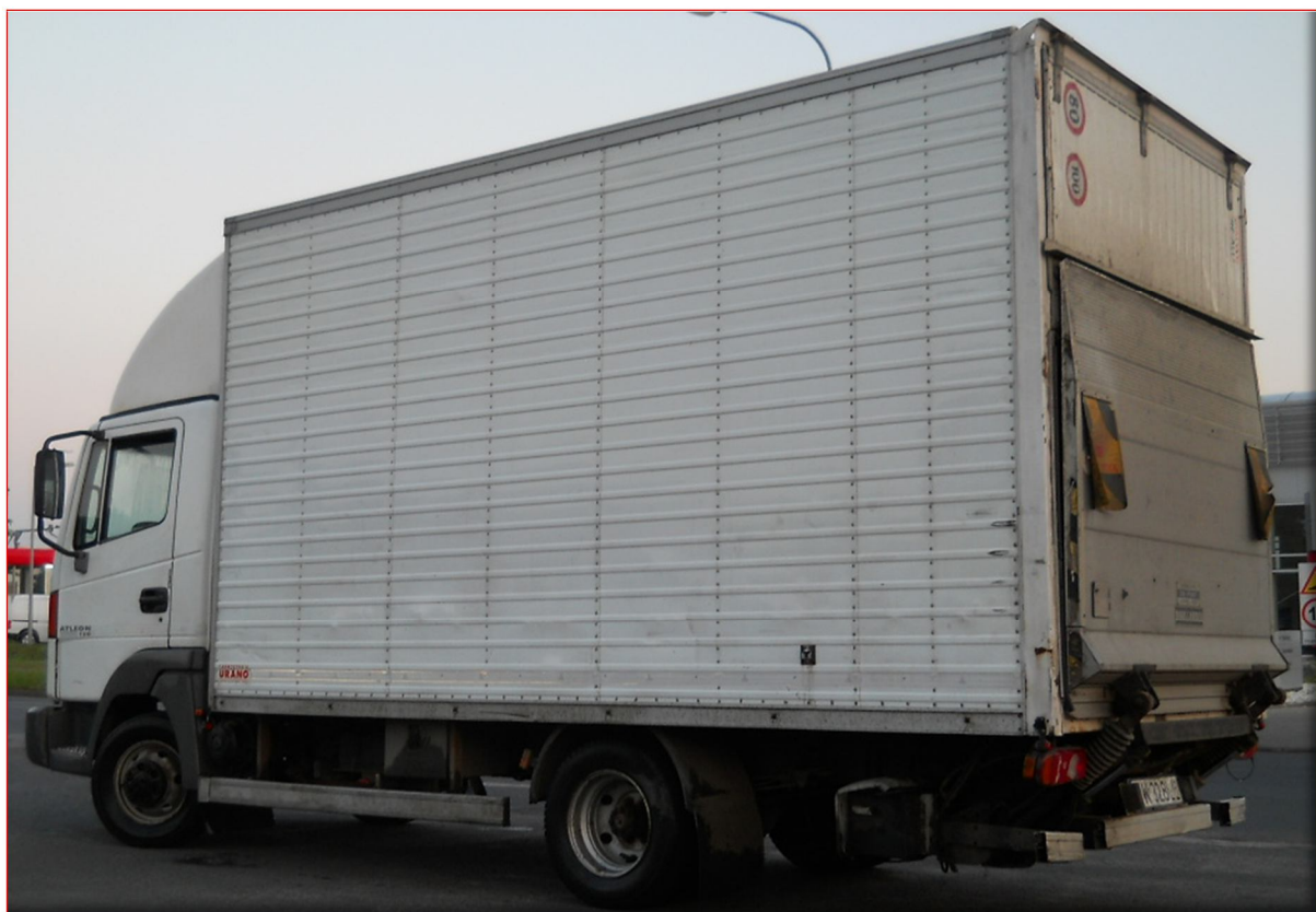
Nissan Atleon, Zabudowa kontener, Wymiary 4,4x2,0x2,3 wysokość, WINDA udźwig 750 kg
